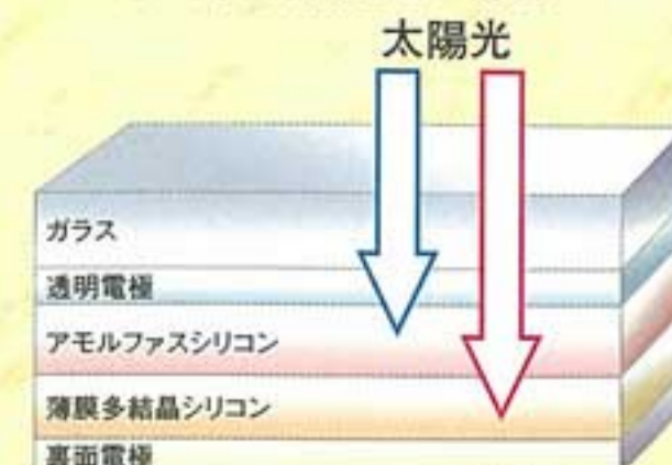
ハイブリッド太陽電池の構造
